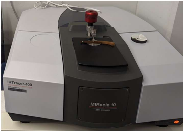
島津製IRTracer-100 FT-IR装置 / MIRacle 10 ATRユニット
