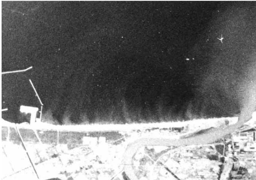
写真-6.2 SPOTの衛星画像による石狩湾河口周辺における縦縞状の濁水流出パターン (1986年10月1日 10:40; 灘岡ら, 1988)
