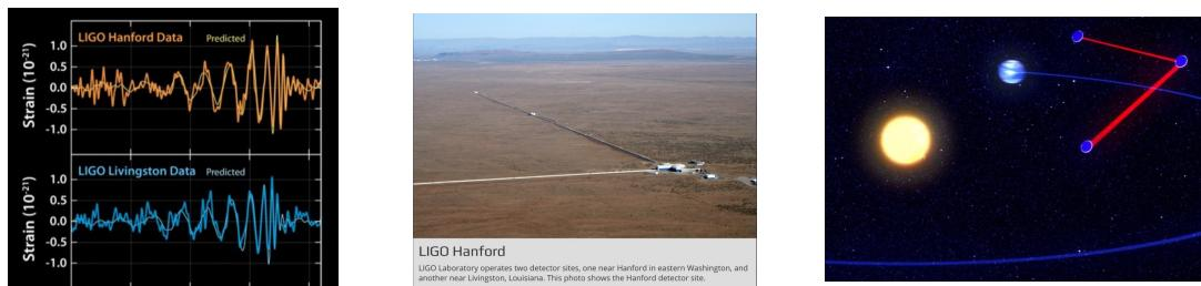
■ 検出器の数とわかる物理 下図のように、検出器 3 台を用いることで重力波の到来方向が決定できるようになる。実際、2017 年に Virgo が加わったことにより重力波の到来方向が決定可能となった。これにより、同一の天体现象由来の電磁波、ニュートリノ、重力波などを同時に観測する「マルチメッセンジャー天文学」の時代が到来した。
