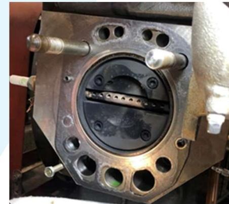
図10 電極を取り付けた様子
