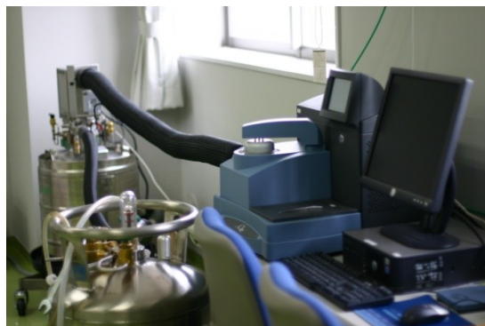
写真 4. 熱分析装置。相転移の検出に不可欠。
